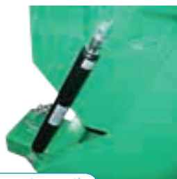
Basculement amorti par vérin
